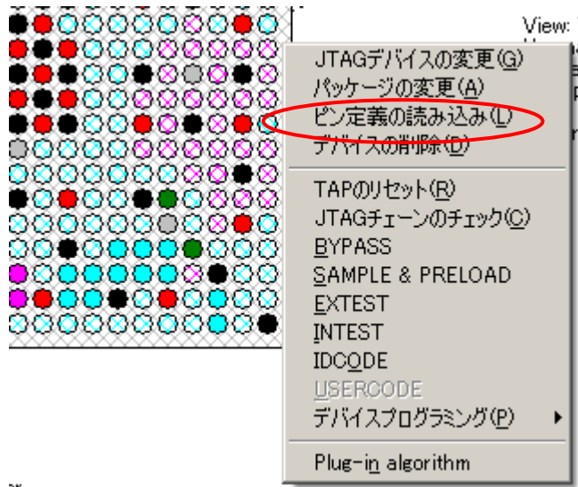
図 3 JTAG ロジックアナライザ起動前にピン定義を読み込む
