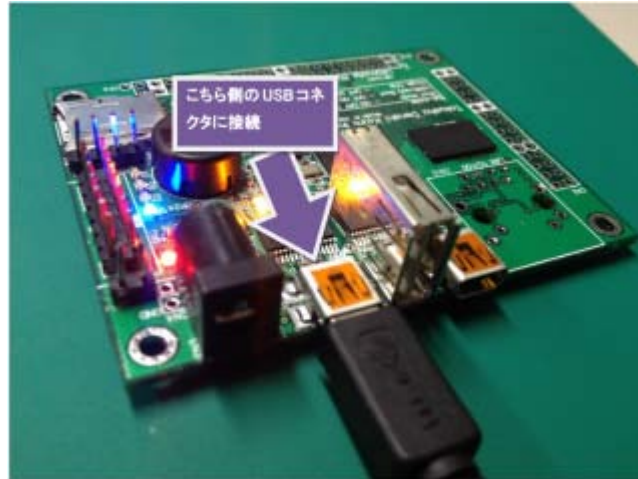
図 12 デバッグ USB コネクタへの接続
